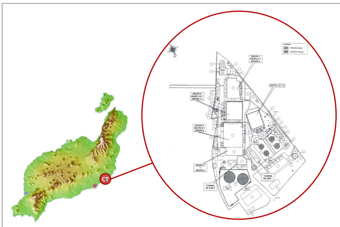
Figura 3.8. Localización de los grupos térmicos dentro de la Central Térmica Punta Grande Elaboración propia. Fuente: Gobierno de Canarias
