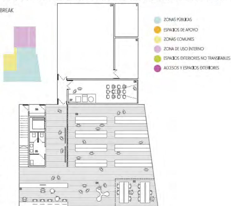
Planta Sótano Cota -3.10m Archivo Escala 1:300 01 INFORMACIÓN 02 ÁREA DE CONSULTA 03 ARCHIVO 04 ÁREA DE DESCANSO 05 ASESOS 06 INSTALACIONES 07 INSTALACIÓN DE ENERGÍA GEOTÉRMICA 08 AULA FORMATIVA 09 ALMACEN GENERAL 10 CUARTO GENERAL DE INSTALACIONES 11 ALJIBE
