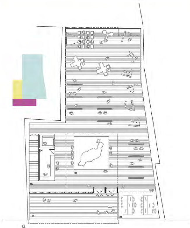
Planta Baja +0.00m Exposiciones Permanentes Escala 1:300 01 VESTIBULO DE ACCESO 02 SALA EXPOSICIONES PERMANENTES 03 DOBLE ALTURA SOBRE ARCHIVO 04 INFORMACIÓN 05 CIRCULACIÓN
